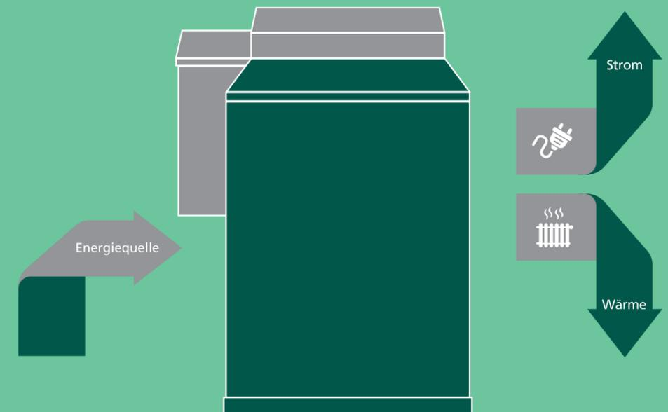
Bei seiner Energieerzeugung stößt ein Dachs rund **30 % weniger CO<sub>2</sub>** aus, als bei der getrennten Erzeugung von Strom und Wärme in Deutschland üblich ist. Mit grünen Gasen, bei deren Verbrennung nicht mehr **CO<sub>2</sub>** freigesetzt wird, als zuvor der Atmosphäre entnommen wurde, arbeitet er sogar **klimaneutral**.
